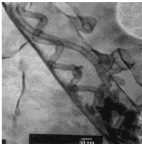
Abbildung 8. TEM-Aufnahme von Kohlenstoff-Nanoröhren, die durch Fe-katalysierte CVD hergestellt wurden, im Inneren von templat-synthetisierten äußeren Röhren („Rohr-im-Rohr-Membran“) (Wiedergabe mit freundlicher Genehmigung aus Nature [15a] ).
